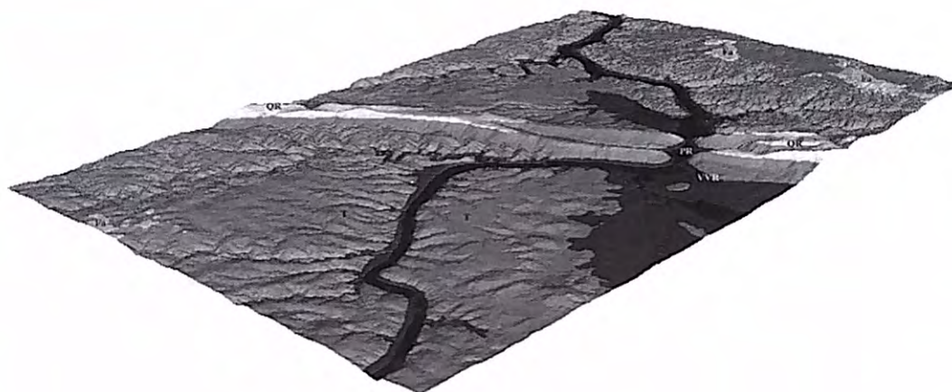
Figura 4 - Vista virtual para sudoeste (MDT), da região de Ródão (Cunha et al. , 2005). Observa-se a morfologia em "sela" correspondente à passagem do curso principal do rio Tejo, anteriormente ao início da etapa de encaixe fluvial; Fa - morfologia em "mesa", correspondente ao topo da Formação de Falagueira (depósitos do rio Tejo anteriores ao encaixe fluvial); PR - Portas de Ródão; QR - crista quartzítica; T - terraços mais altos; VVR - Vila Velha de Ródão. Altimetria: preto - 74 a 82 m; cinzento escuro - 82 a 120 m; cinzento - 120 a 302 m; branco - 302 a 470 m.
